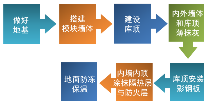
图 2 一体化冷库施工工艺流程
