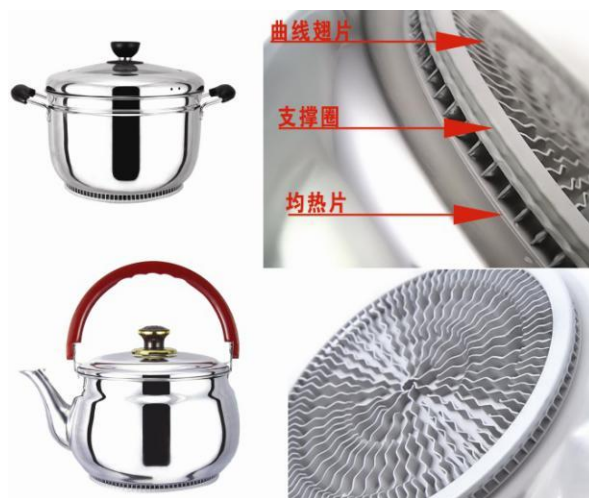
图 1 基于翅片式换热结构的不锈钢炊具示意图
