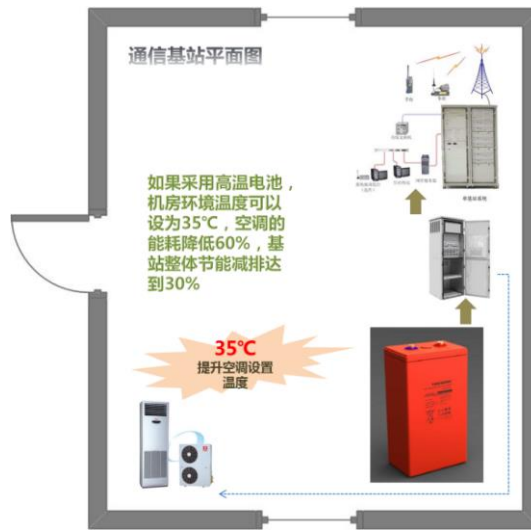
图2 耐高温型密封电池应用于通信基站示意图
